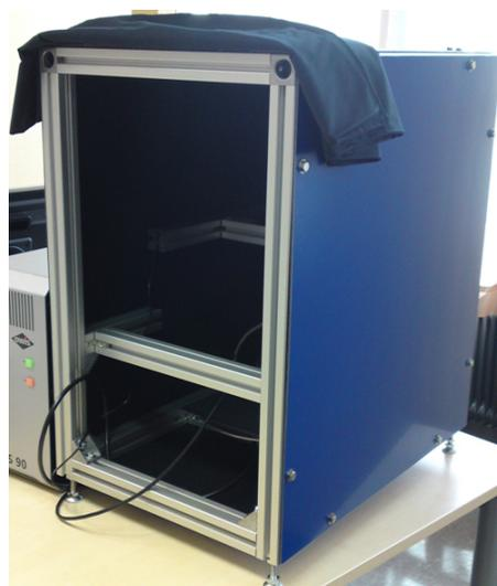
**Abbildung 4.3.:** Verkleidung des Laserscanners.
