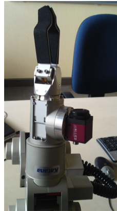
Abbildung 4.4: Am Katana-Greifarm befestigte FireWire-Kamera.
