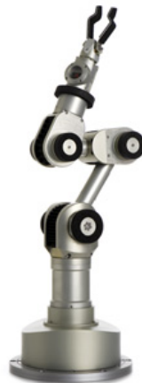
Abbildung 4.1: Katana-Greifarm mit fünf Gelenken und einem Zwei-Finger-Greifer. [NEU10]
