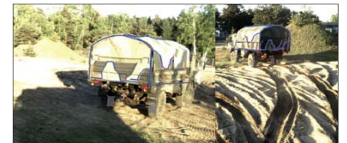
Abb. 4: Autonome Konvoifahrt des TULF hinter Führungsfahrzeug vom Typ MAN 5t mil gl. Die Merkmale aus dem 3D-Modell werden gemäß der geschätzten 3D-Fahrzeugposition in die Bildebene projiziert und dem Kamerabild überlagert dargestellt
