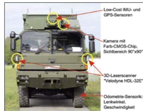
Abb. 2: TULF mit eingerüsteter Sensorik. Nur die für das automatisierte Folgen verwendeten Sensoren sind beschriftet
