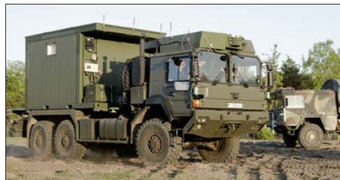
Abb. 1: TULF (Technologieträger Unbemanntes Landfahrzeug) im Testgelände. Der Rheinmetall MAN Military Vehicles (RMMV) HX58 wurde mit einem Drive-By-Wire-System, Sensorik und Rechnern zu einer Robotik-Plattform umgerüstet. Der montierte Leitstandscontainer dient zur Teleoperation. Im Hintergrund ein Führungsfahrzeug vom Typ MAN 5t mil gl
