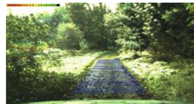
Abb. 3: Visuell erkannter Feldweg in unstrukturierter Umgebung mit Darstellung der Erkennungsgüte
