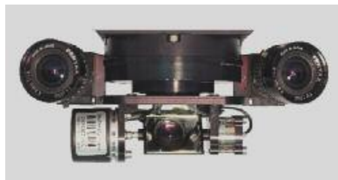
Abb. 2: MarVEye8: dem menschlichen Auge nachempfundene Kameraplattform (großer Blickwinkel und hohe Auflösung im Sichtzentrum, Bildstabilisierung und schnelle Sakkaden)
