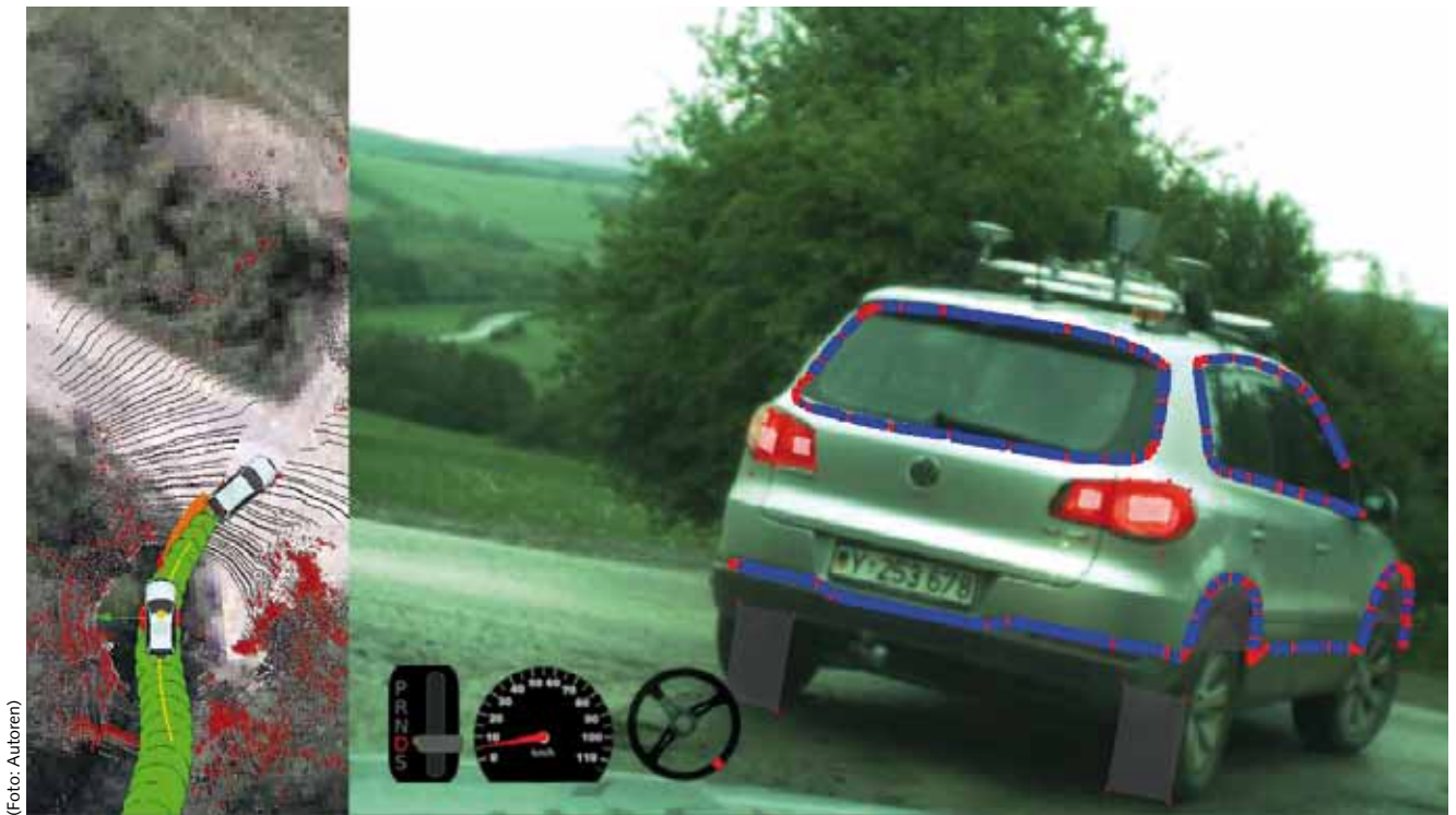
Linke Seite: Darstellung der internen Modellvorstellung von MuCAR-3. Rechte Seite: Überlagerung der internen Modellvorstellung (3D-Modell des VW Tiguan) mit den realen Daten eines Kamera-Farbbilds
