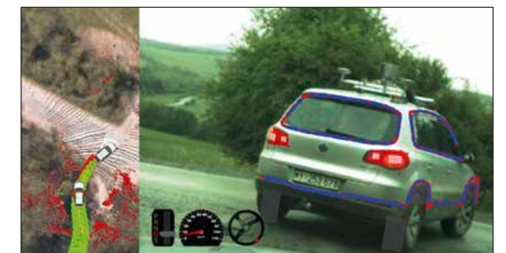
Abb. 4: Visualisierung der Fahrspurgenerierung (links), wobei die grünen Punkte die lokalen Wegpunkte und deren Positionsunsicherheit repräsentieren. Zusätzlich sind die Hindernisdaten (rote Punkte) in ein georeferenziertes Luftbild eingetragen. Auf der rechten Seite ist die interne Modellvorstellung dem realen Farbbild überlagert
